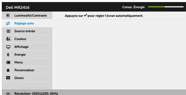
Le **Réglage auto** permet au moniteur de s'adapter automatiquement au signal vidéo entrant. Après avoir utilisé la fonction **Réglage auto**, le réglage du moniteur peut être retouché en utilisant les commandes d'**Horloge pixel** (grossier) et de **Phase** (fin) sous les paramètres d'**Affichage**.
